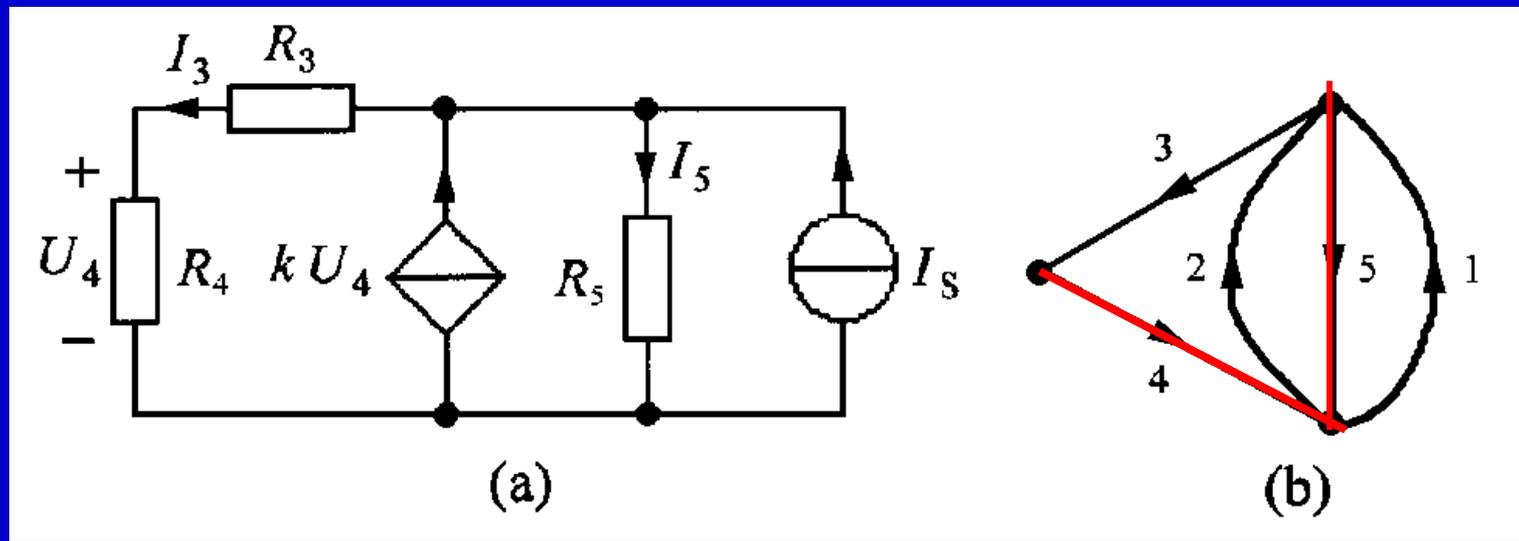
可以用观察电路的方法写出以树支电压和连支电流作为变量的电路方程。如下所示。
