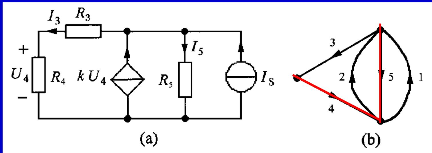
图(a)所示电路的定向图如图(b)所示，选择支路4和5作为树支，则支路1、2、3为连支。由此可以列出KCL和KVL方程，如下所示：
