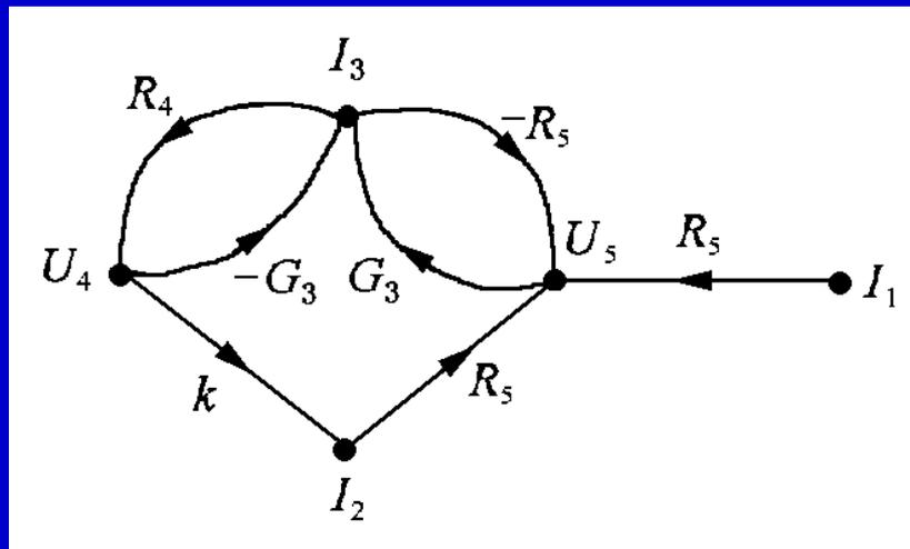
例如由节点 $I_1$ 到节点 $U_5$ 的 $P=R_5$ 。移去由节点 $I_1$ 到节点 $U_5$ 的通路后子图的行列式为
