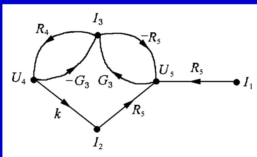
$L$ 表示信号流图的回路，上图有三个一阶回路，即
