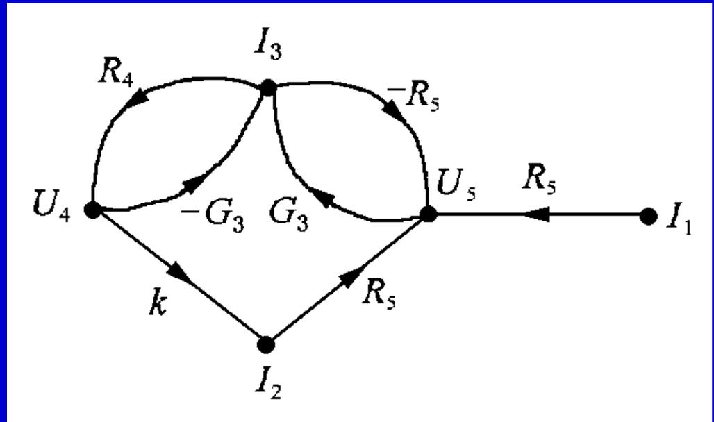
分子中的 $P_i$ 表示由输入节点到输出节点正向通路增益之乘积。例如由节点 $I_1$ 到节点 $U_5$ 的 $P=R_5$ 。
