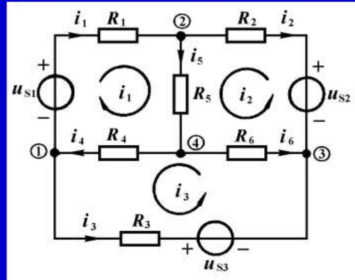
其中 $R_{11}$ ,  $R_{22}$ 和 $R_{33}$ 称为网孔自电阻，它们分别是各网孔内全部电阻的总和。例如 $R_{11} = R_1 + R_4 + R_5$ ,  $R_{22} = R_2 + R_5 + R_6$ ,  $R_{33} = R_3 + R_4 + R_6$ 。
