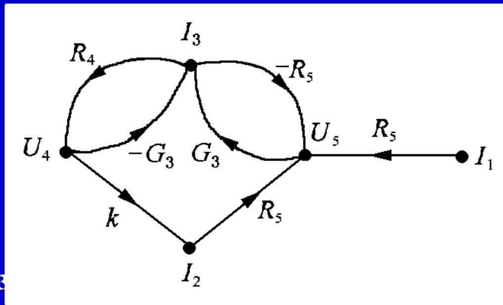
这个信号流图可以用观察电路图的方法直接画出来。
