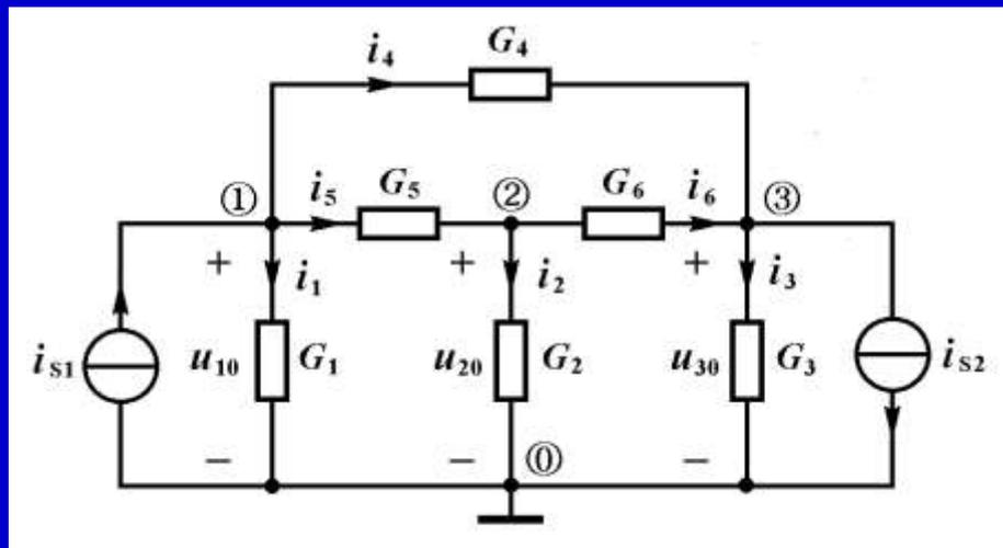
$$\left. \begin{aligned} i_1 + i_4 + i_5 &= i_{S1} \\ i_2 - i_5 + i_6 &= 0 \\ i_3 - i_4 - i_6 &= -i_{S2} \end{aligned} \right\}$$
