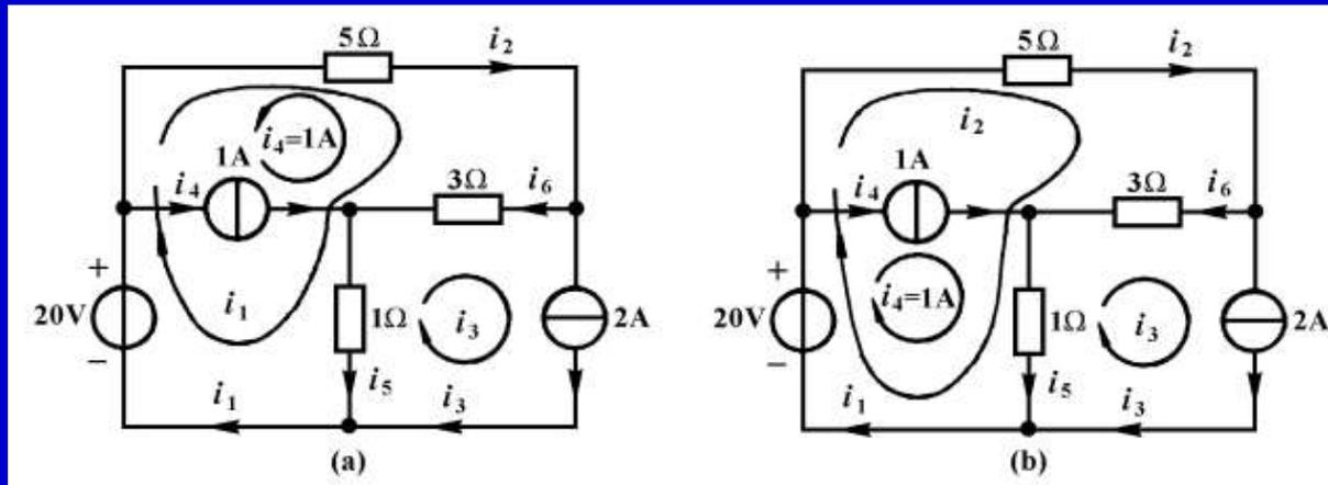
假如选择图3-21(b)所示的三个回路电流 $i_2$ ,  $i_3$ 和 $i_4$ , 由于 $i_3=2A$ ,  $i_4=1A$ 成为已知量, 只需用观
