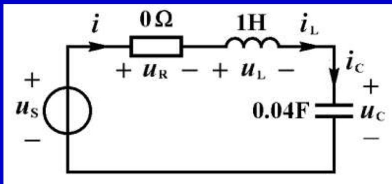
图9-1  $RLC$ 串联二阶电路
