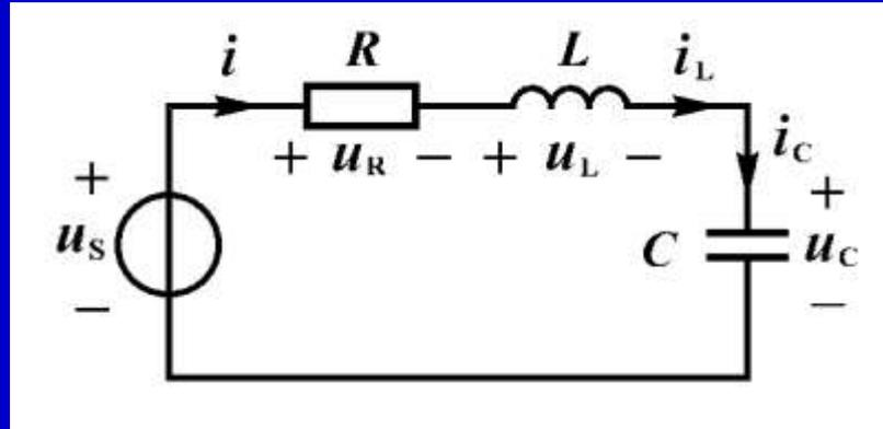
对于图示直流激励的 $RLC$ 串联电路，当 $u_S(t)=U_S$ 时，可以得到以下非齐次微分方程
