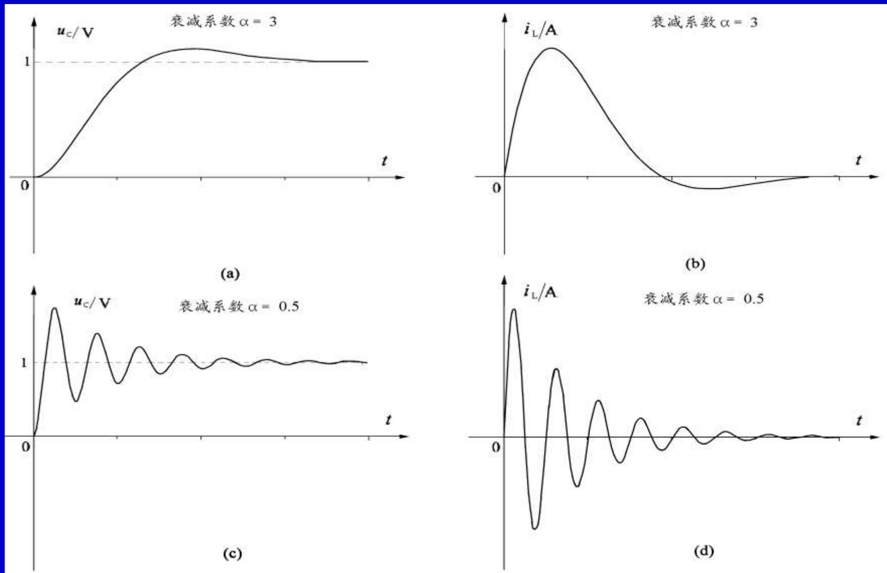
注：图(c)和(d)表示当电阻由 $R=6\Omega$ 减小到 $R=1\Omega$ ，衰减系数由3变为0.5时的电容电压和电感电流零状态响应的波形曲线。
