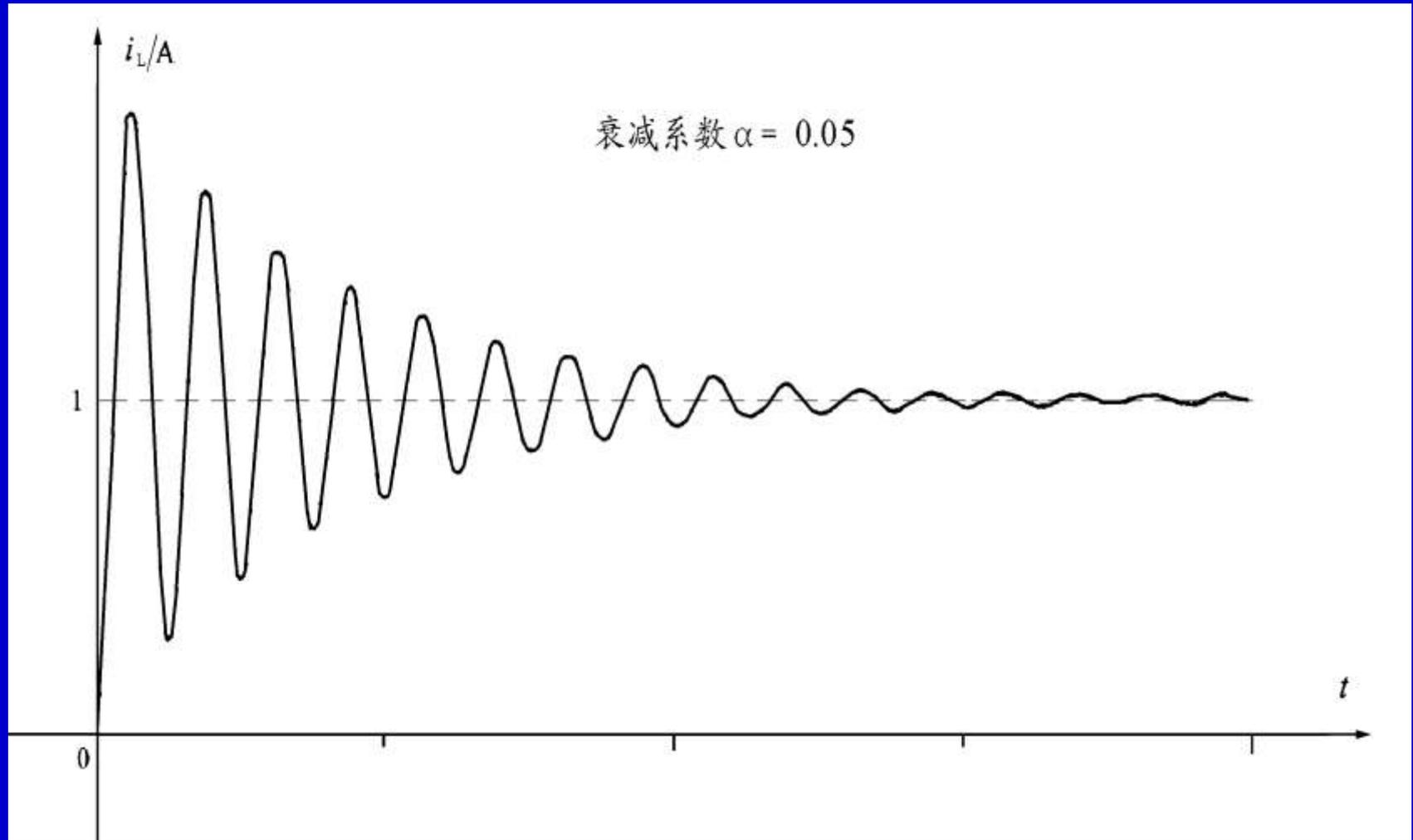
衰减系数为0.05的电感电流的波形
