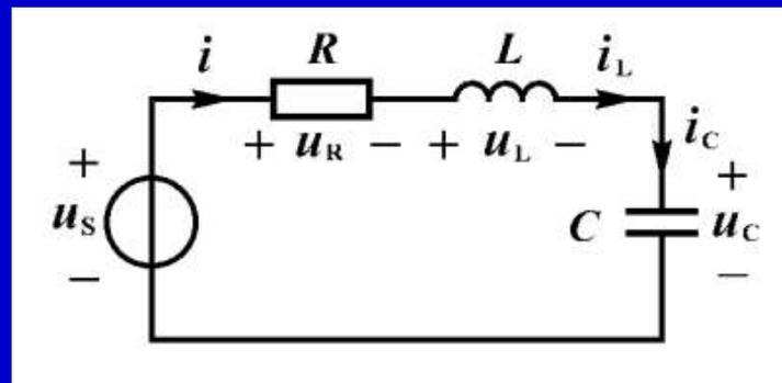
图9—1  $RLC$ 串联二阶电路
