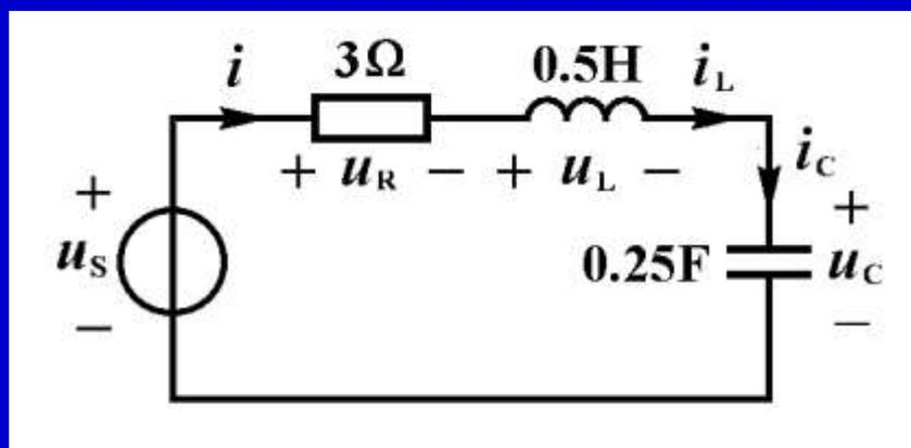
图9-1  $RLC$ 串联二阶电路
