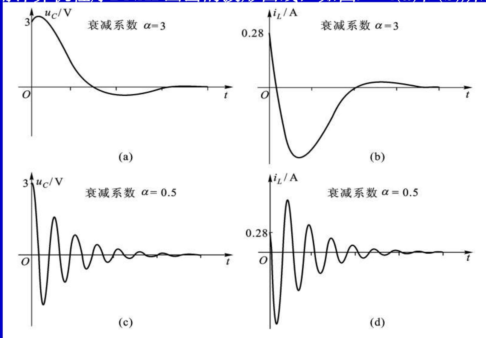
(a) 衰减系数为3的电容电压的波形
