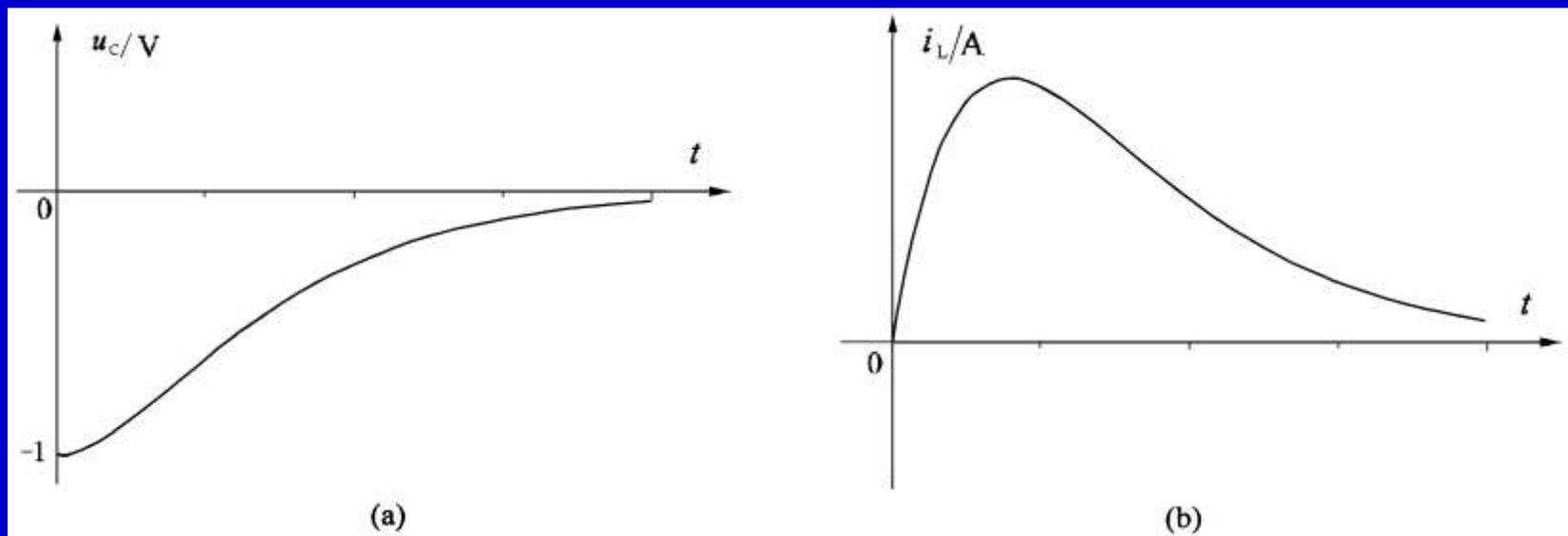
(a) 电容电压的波形
