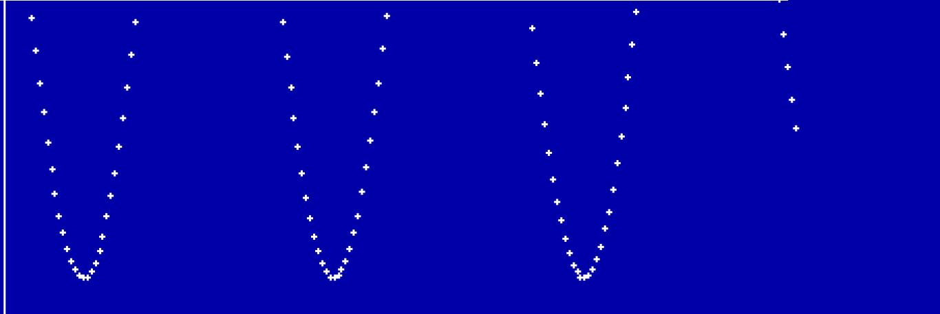
从电容电压和电感电流的表达式和波形曲线可见，由于电路中没有损耗，能量在电容和电感之间交换，总能量不会减少，形成等振幅振荡。电容电压和电感电流的相位差为 $90^\circ$ ，当电容电压为零，电场储能为零时，电感电流达到最大值，全部能量储存于磁场中；而当电感电流为零，磁场储能为零时，电容电压达到最大值，全部能量储存于电场中。
