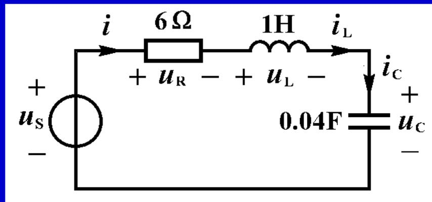
图9-1  $RLC$ 串联二阶电路
