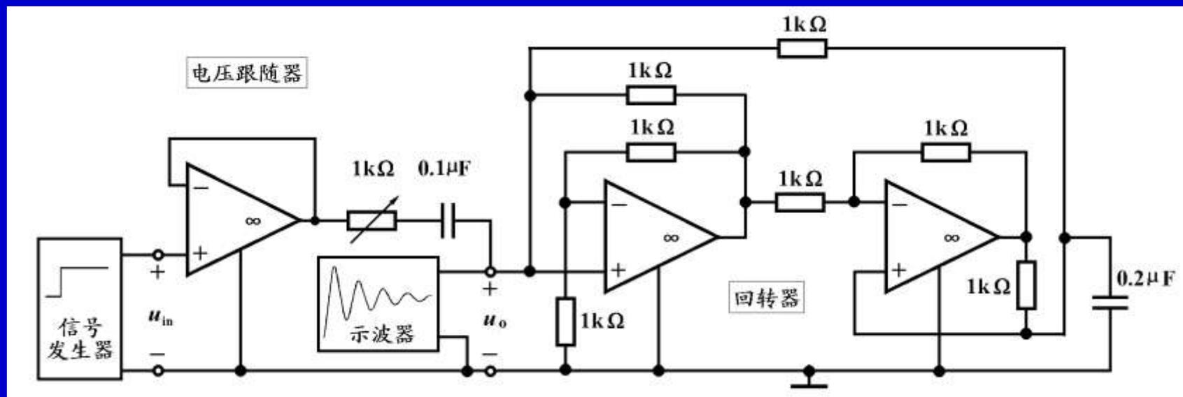
图9-15 观察RLC串联电路阶跃响应的试用电路
