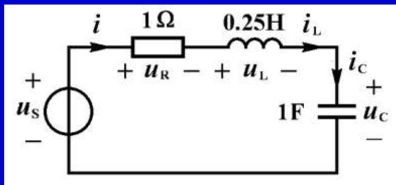
图9-1 RLC串联二阶电路
