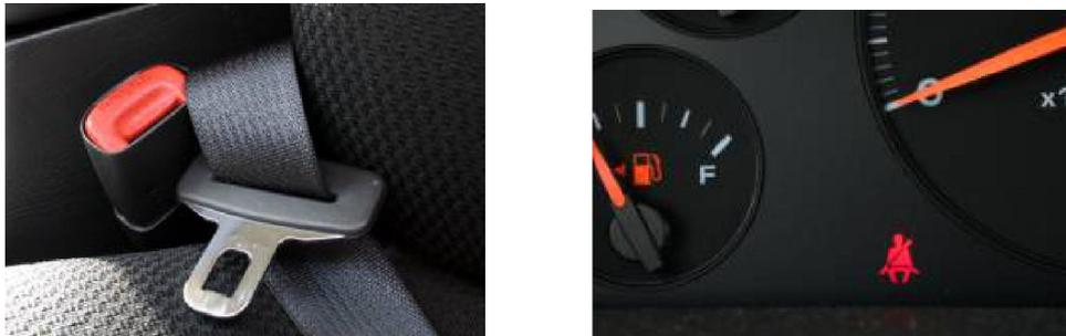
图 5.3 汽车安全带及警示灯
